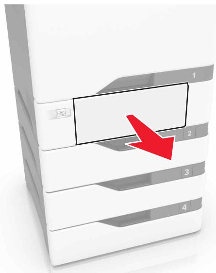
**Upozorenje – potencijalno oštećenje:** Senzor unutar opcione fioke može lako da se ošteti statičkim elektricitetom. Dodirnite metalnu površinu pre uklanjanja zaglavljenog papira u fioci.
