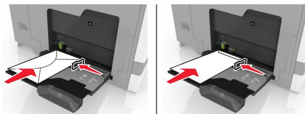
**警告—破損の恐れあり:** 切手、留め金、スナップ、窓、つや出し加工された内張り、封かん用口糊の付いた封筒は使用しないでください。
