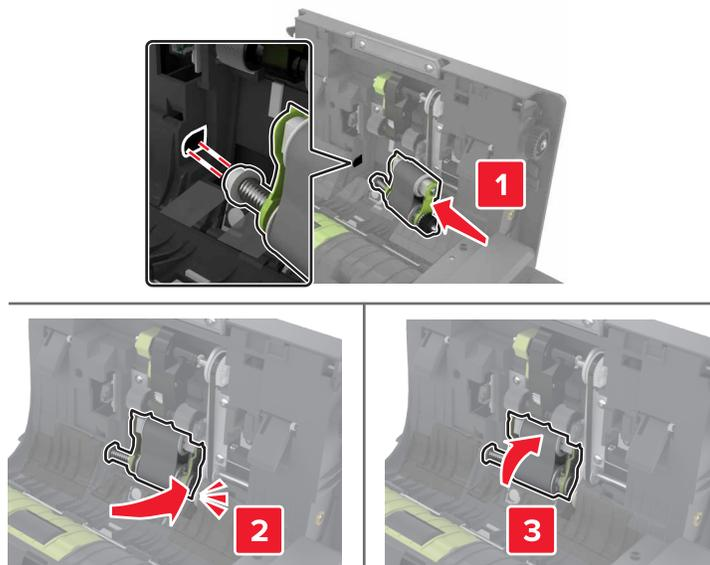
7 ADF ピックローラーカバーを「カチッ」と音がするまで挿入します。
