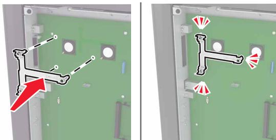
**6** ブラケットに ISP を取り付けます。
