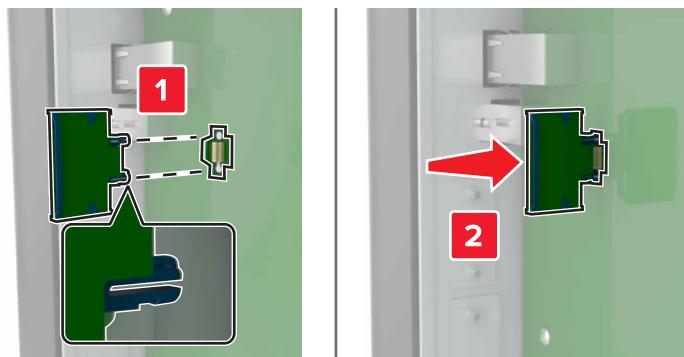
**Notă:** Întreaga lungime a conectorului cardului trebuie să atingă și să fie la același nivel cu placa de sistem.
