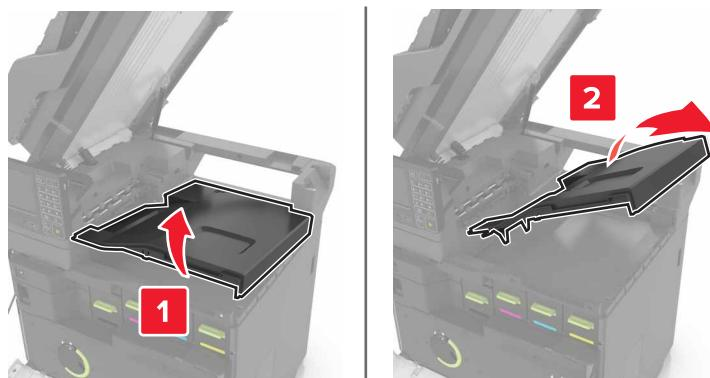
**6** Scoateți capacul conectorului finisorului cu capse.
