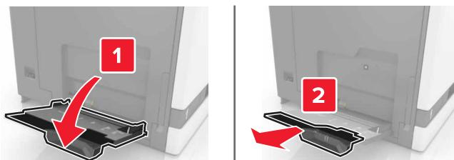
**2** Reglați ghidajul pentru a se potrivi cu dimensiunea hârtiei pe care o încărcați.
