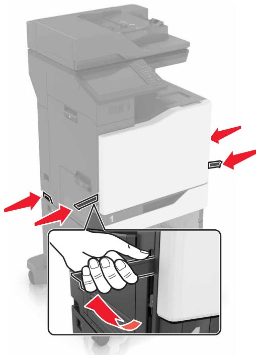
**Notă:** Dacă sunt deja instalate tăvi optionale, deblocați-le din imprimantă înainte de a ridica imprimanta. Nu încercați să ridicați imprimanta și tăvile simultan.
