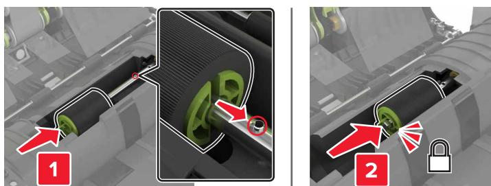
**7** Introduceți capacul rolei de separare a unității ADF până când aceasta se fixează cu un *clic* în poziție.
