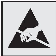
此符号指出静电敏感的部件。在没有先触摸远离该符号的区域内的金属表面时，不要接触靠近这些符号的区域。在执行维护任务（如清除卡纸或更换耗材）时，为防止静电放电造成的损坏，即使符号不存在，也请在进入或接触打印机的内部区域之前触摸打印机的任何外露金属框架。
