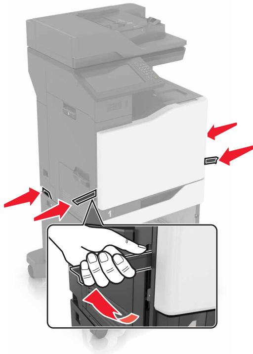
**注意:** 如果已经安装进纸匣选件, 请在抬起打印机之前从打印机上解锁它们。不要尝试同时抬起打印机和进纸匣。
