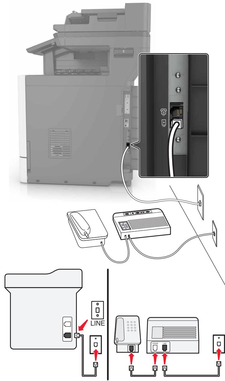
**1** 将电话线的一端连接到打印机的线路端口。
