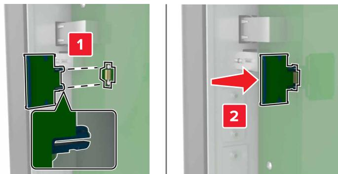
**注意:** 卡上的整个连接器必须完全接触控制器板，并平整地挨着控制器板。
