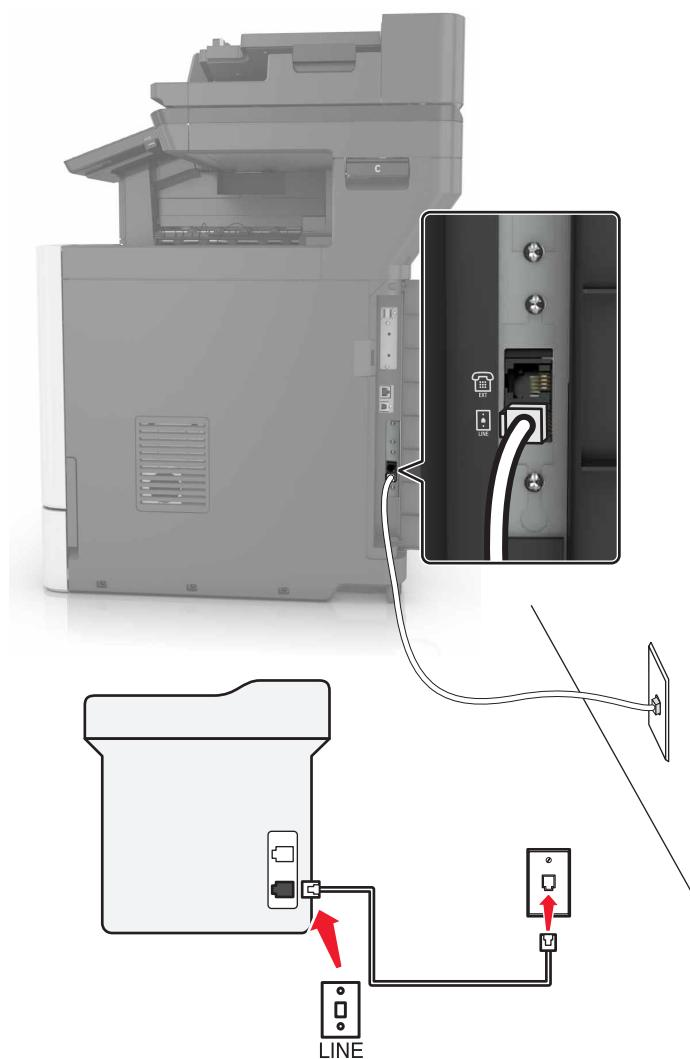
**1** 将电话线的一端连接到打印机的线路端口。
