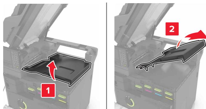
6 移除装订完成器连接器盖板。
