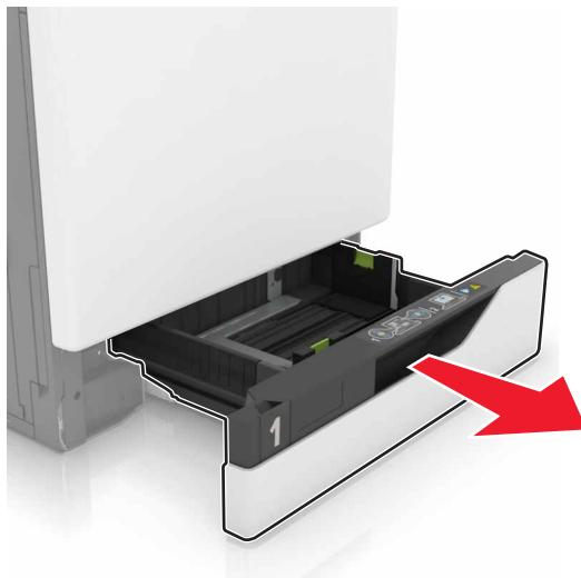
**2** 调整导片以匹配加载的纸张尺寸。
