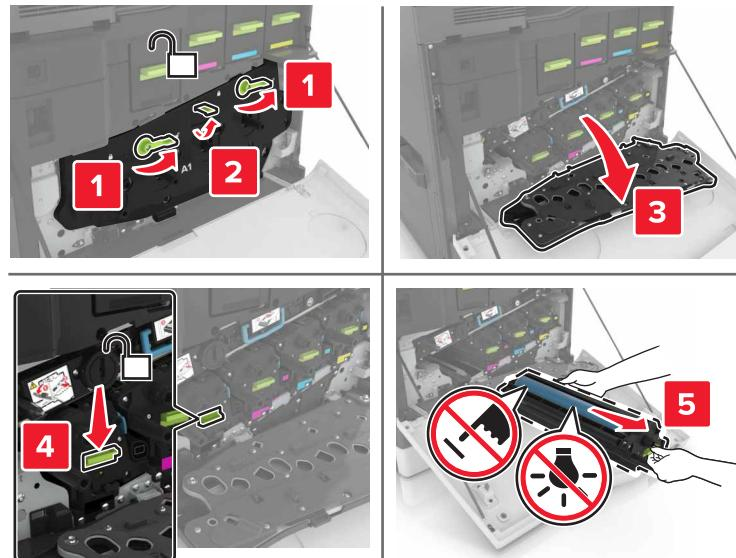
**4 移除显影部件。**
