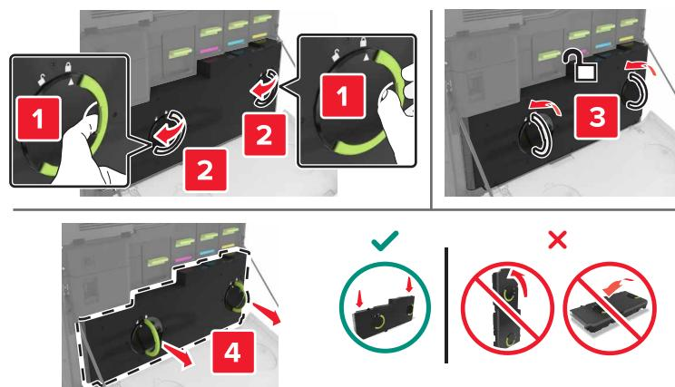
**3 移除成像部件。**
