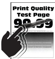
**注意：**在解决问题之前，请打印“打印质量测试页”。从主屏幕，触摸 **设置 > 疑难解答 > 打印质量测试页**。
