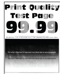
**ملاحظة:** قبل حل المشكلة، اطبع صفحات اختبار جودة الطباعة. من لوحة التحكم، انتقل إلى الإعدادات > استكشاف الأخطاء وإصلاحها > صفحات اختبار جودة الطباعة.
