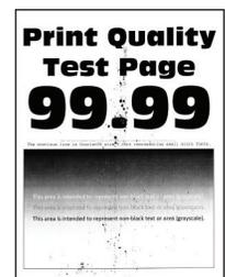
**ملاحظة:** قبل حل المشكلة، اطبع صفحات اختبار جودة الطباعة. من لوحة التحكم، المس الإعدادات < استكشاف الأخطاء وإصلاحها < صفحات اختبار جودة الطباعة.
