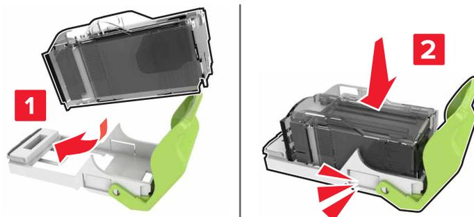
7 Einsetzen der Halterung der Heftklammerkassette, bis sie hörbar *einrastet*.
