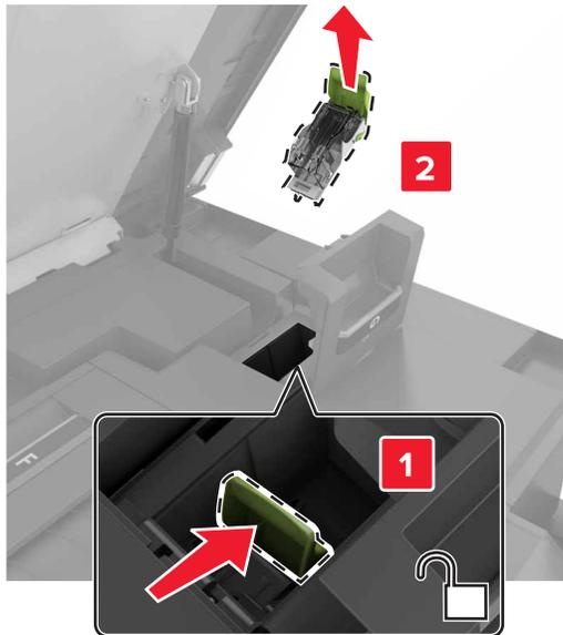
**4** Heben Sie den Heftklammerschutz an, und entfernen Sie anschließend alle losen Heftklammern.
