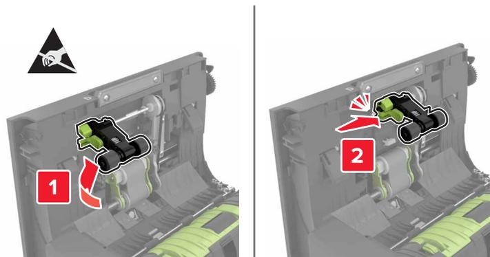
7 Setzen Sie die neue Einzugsrolle ein, bis sie mit einem *Klick* einrastet.
