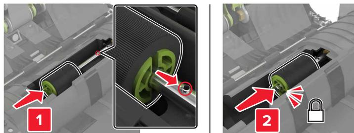
**7** Setzen Sie die ADZ-Trennrolle ein, bis sie hörbar *einrastet*.
