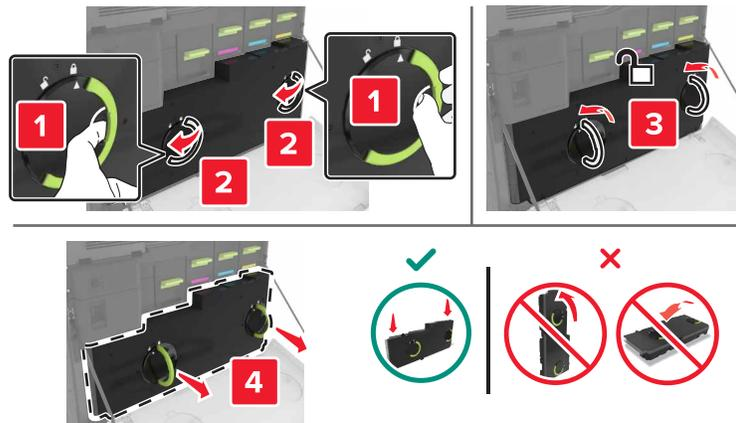
**3** Entfernen Sie die Belichtungseinheit.
