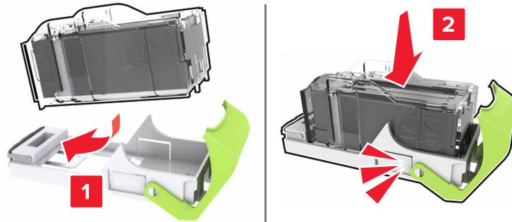
6 Einsetzen der Halterung der Heftklammerkassette, bis sie hörbar *einrastet*.
