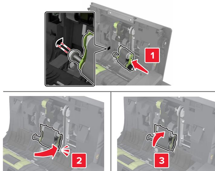
7 Setzen Sie die neue Einzugsrolle ein, bis sie mit einem *Klick* einrastet.
