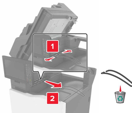
**4** Entfernen Sie die Abdeckungen vom Papiertransport und vom Heftklammer-Finisheranschluss.
