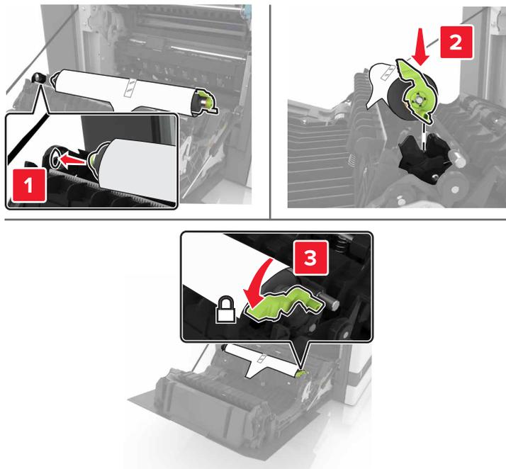
**5** Entfernen Sie das weiße Verpackungsmaterial.
