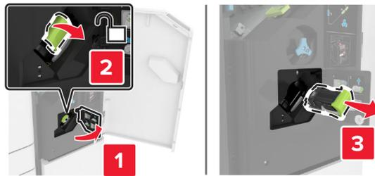
3 Entfernen Sie die Heftklammerkassette.
