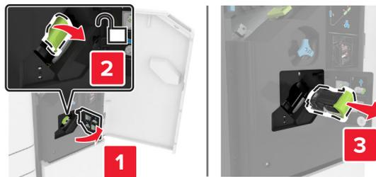
3 Öffnen Sie den Heftklammerschutz und entfernen Sie anschließend alle losen Heftklammern.
