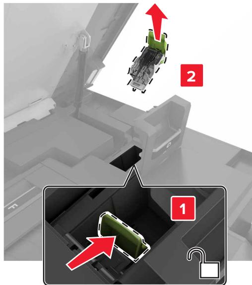
**4** Entfernen Sie die Heftklammerkassette.
