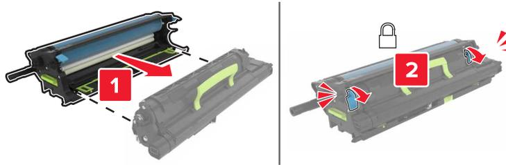
**7** Setzen Sie die Belichtungseinheit ein.
