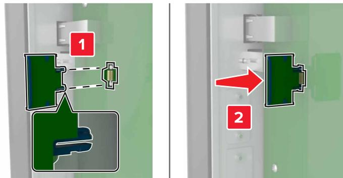
**Hinweis:** Der Steckverbinder auf der Karte muss über die gesamte Länge bündig an der Controller-Platine anliegen.
