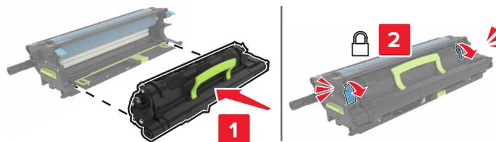
7 Setzen Sie die Belichtungseinheit ein.
