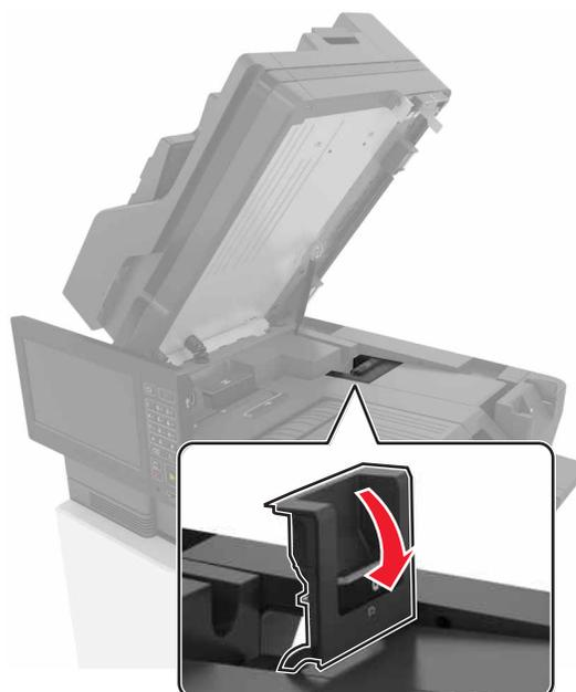
**3** Entfernen Sie die Heftklammerkassette.
