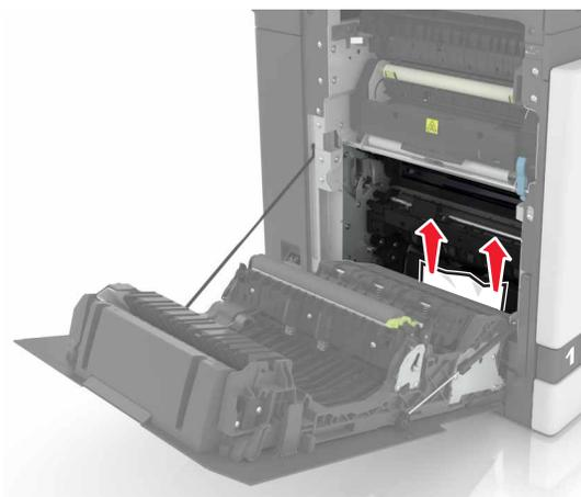
**3** Åpne dekselet til fikseringsenheten.
