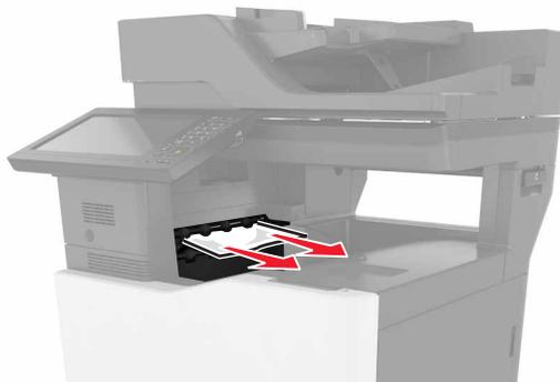
2 Åpne deksel B, og fjern fastkjørte papirdeler.
