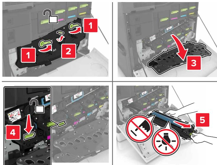
4 Uklonite jedinicu razvijača.
