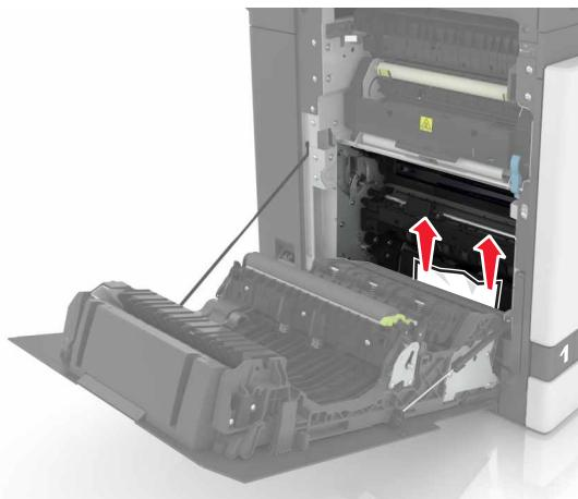
3 Otvorite vrata za pristup jedinici za nanošenje tonera.
