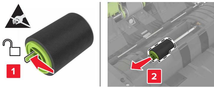
5 Otpakujte novi valjak separatora automatskog ulagača.
