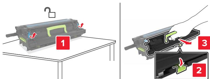
5 Otpakujte novu jedinicu razvijača, a zatim uklonite materijal za pakovanje.
