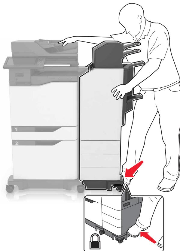
Proverite da li su finišer i štampač pravilno spojeni tako što ćete snažno pokušati da odvojite finišer od štampača. Ako se finišer odvoji od štampača, ponavljajte korake [korak 13](#) do [korak 14](#) dok ne budu pravilno spojeni.
