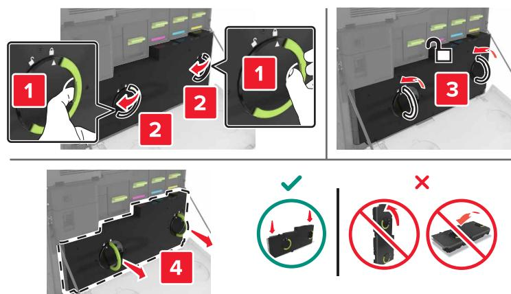
3 Uklonite jedinicu za izradu slika.
