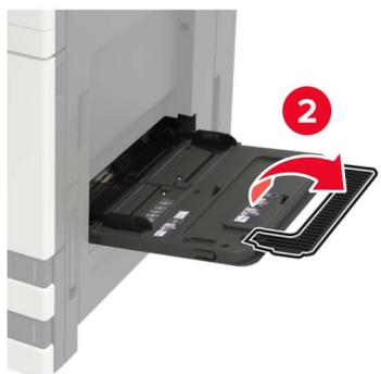
2 Ajuste las guías para que coincidan con el tamaño del papel que va a cargar.
