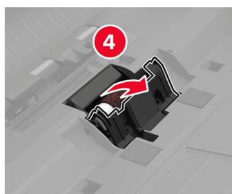
**3** Retire el rodillo de separación del ADF.
