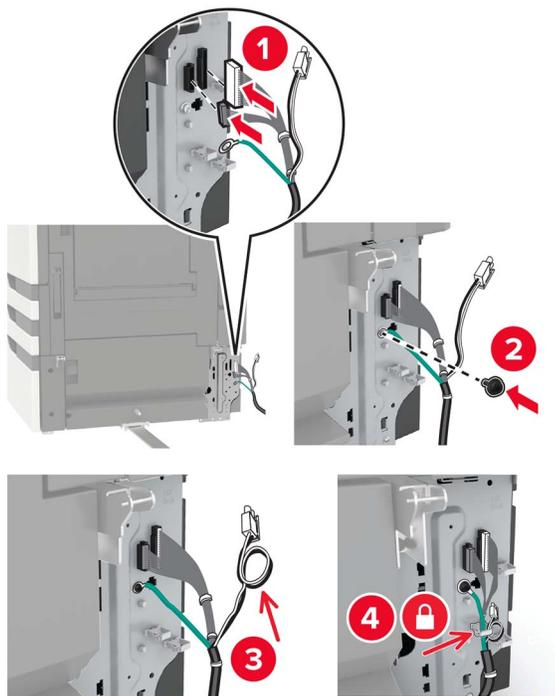
**19** Monte la cubierta del cable de la bandeja.
