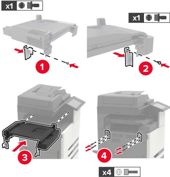
8 Conecte el dispositivo de acabado a la impresora.
