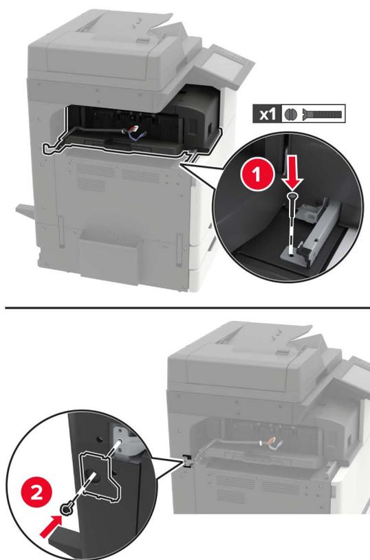
**11** Monte la cubierta del carril deslizante del dispositivo de acabado.
