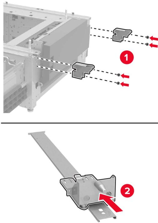
**13** Monte el carril y, a continuación, el soporte de montaje y las cubiertas de carril.
