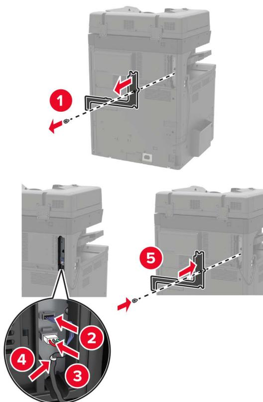
**14** Vuelva a colocar la cubierta del filtro.
