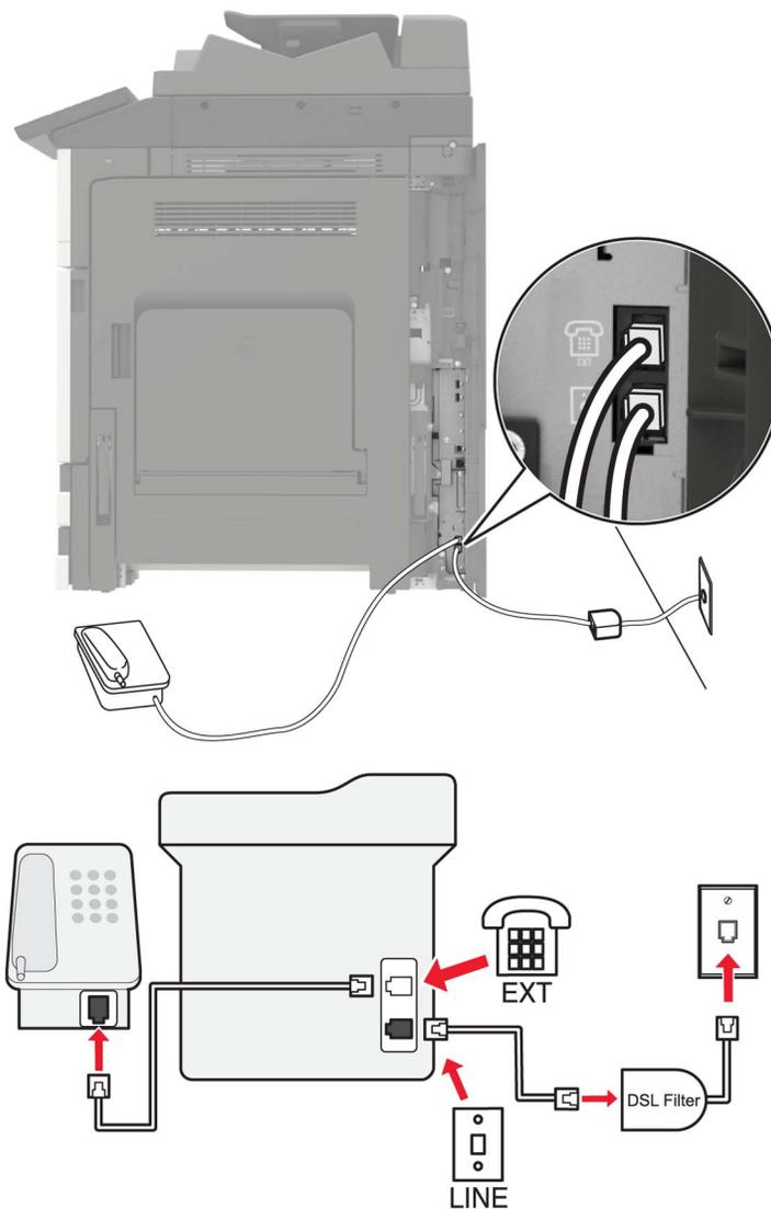
Una línea digital de abonado (DSL) divide la línea de teléfono habitual en dos canales: voz e Internet. Las señales de teléfono y fax viajan a través del canal de voz mientras que la señal de Internet transcurre por el otro canal.
