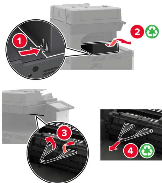
6 Retire las guías de papel con el destornillador almacenado dentro de la puerta A.
