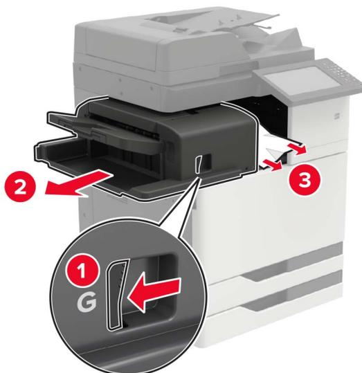
Si nécessaire, tournez la roue tournante G1 vers le bas pour insérer le papier coincé dans le réceptacle d'unité de finition, puis retirez le papier coincé.
