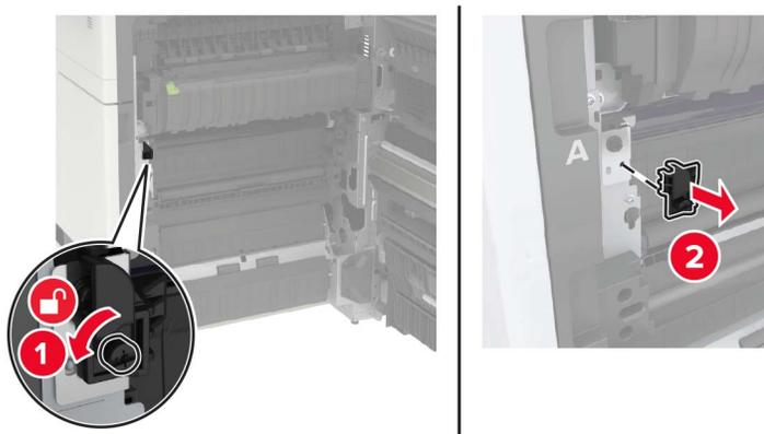
**4** Desserrez les vis qui fixent la courroie de transfert.
