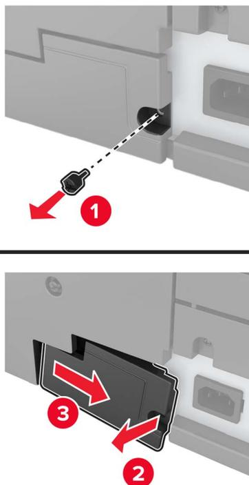
**4** Si l'imprimante est équipée d'un capot de filtre, retirez-le.
