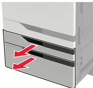
**9** Fixez le tiroir à l'imprimante à l'aide des pattes de verrouillage et du support métallique.
