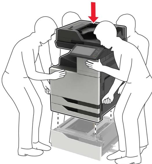
**16** Alinhe a bandeja para 3000 folhas à impressora e encaixe o pino de montagem.
