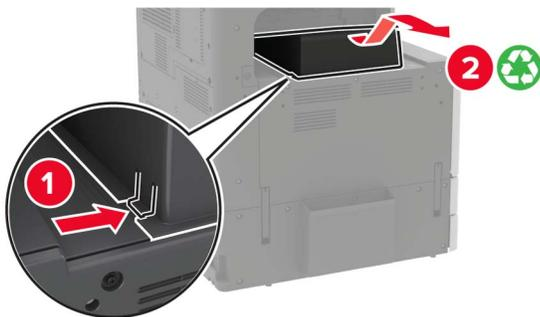
**5** Remova a tampa adesiva e, em seguida, remova o depósito de papel.
