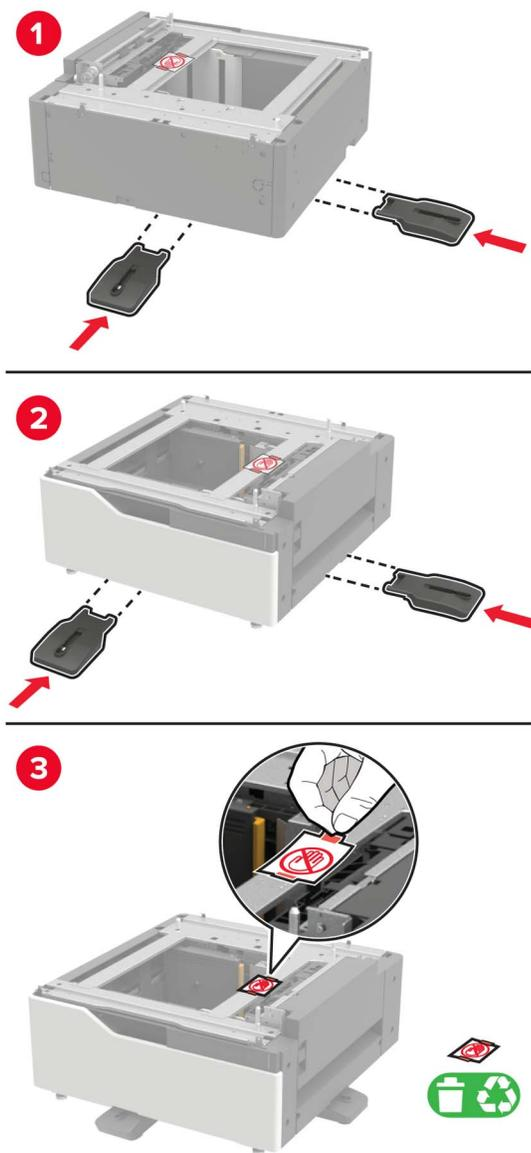
5 Usando as alças laterais, alinhe a impressora à bandeja e encaixe a impressora no lugar.
