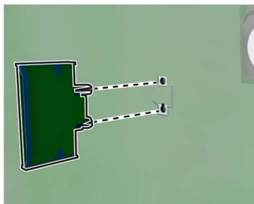
**9** Encaixe a proteção e, em seguida, encaixe a tampa de acesso.
