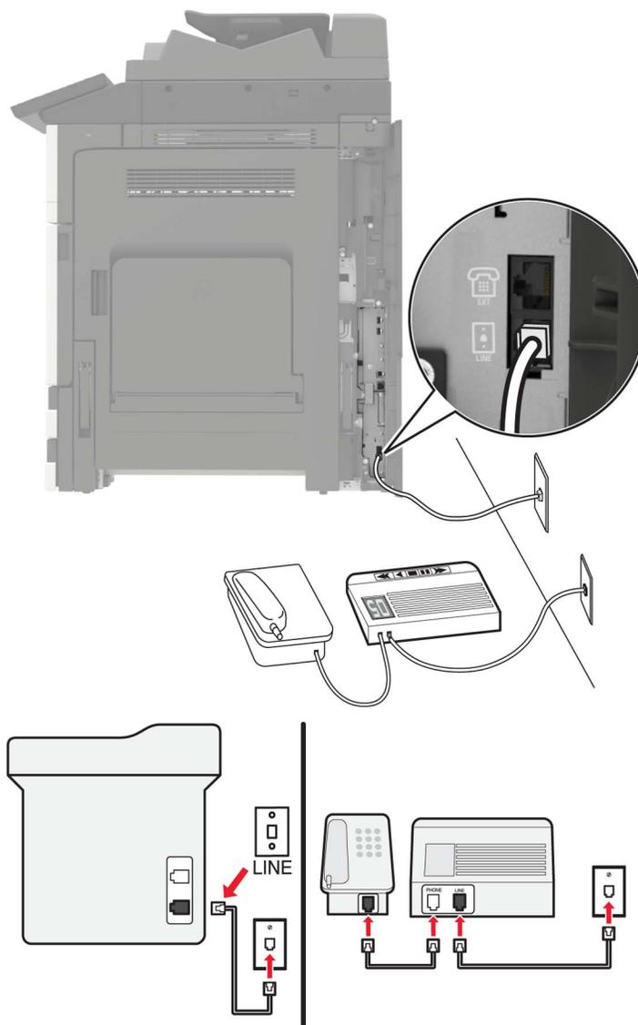
**1** Conecte uma extremidade do cabo de telefone à porta line da impressora.
