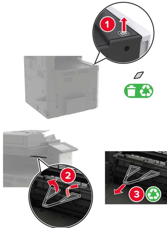
**6** Com a chave de fenda armazenada dentro da porta A, remova as tampas do sensor de guia de papel e do trilho de deslizamento.
