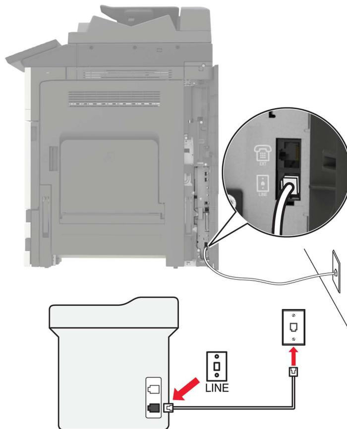
**1** Conecte uma extremidade do cabo de telefone à porta line da impressora.
