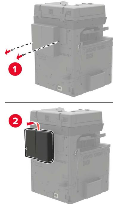
**5** Снимите защитную крышку системной платы.
