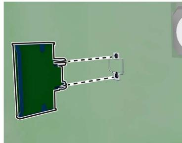
**Примечание:** Разъем платы микропрограммного обеспечения должен соприкасаться с системной платой по всей длине и располагаться в одной плоскости с ней.
