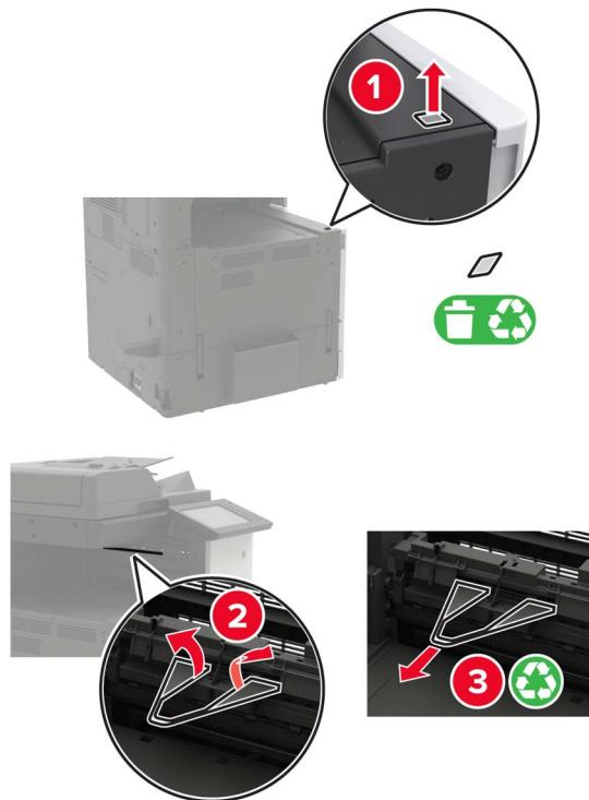
**6** Отверткой, которая хранится в дверце А, снимите крышки датчиков направляющих бумаги и сдвиньте направляющую.
