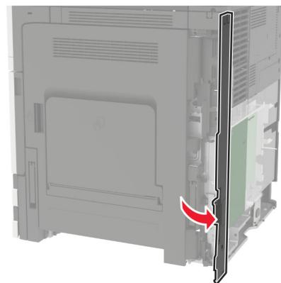
**6** Снимите крышку разъема для дополнительного оборудования.
