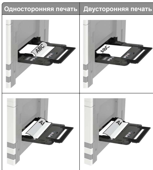
**Предупреждение – Риск повреждения!** При использовании конвертов не допускается печатать на конвертах с марками, застежками, защелками, окнами, рельефным покрытием и самоклеящимися полосками.
