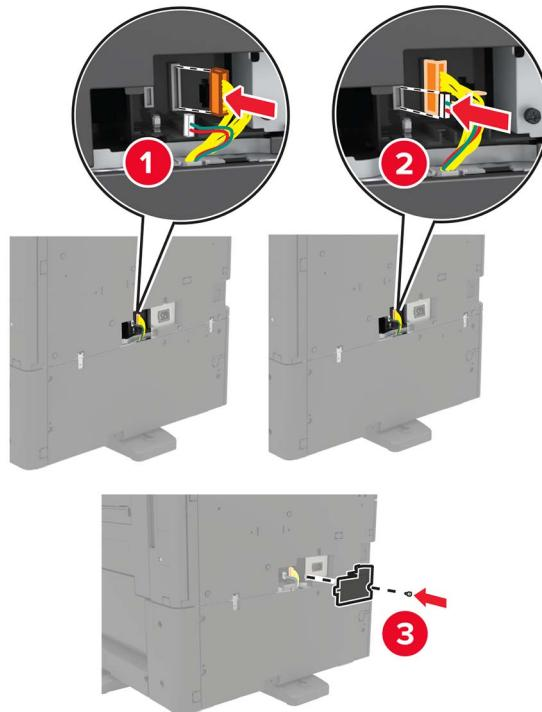
**23** Откройте лотки 2 и 3, затем закрепите лотки на 2 x 500 или 2500 листов на принтере зажимами и металлической скобой.
