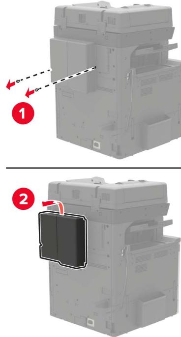
5 Снимите защитную крышку системной платы.
