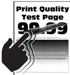
**注意:** 在解决问题之前, 请打印“打印质量测试页”。从控制面板, 导览至设置 > 疑难解答 > 打印质量测试页。对于非触摸屏打印机型号, 请按 **OK** 来浏览设置。
