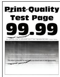
**注意：**在解决问题之前，请打印“打印质量测试页”。从控制面板，导航至**设置 > 疑难解答 > 打印质量测试页**。对于非触摸屏打印机型号，请按 **OK** 来浏览设置。
