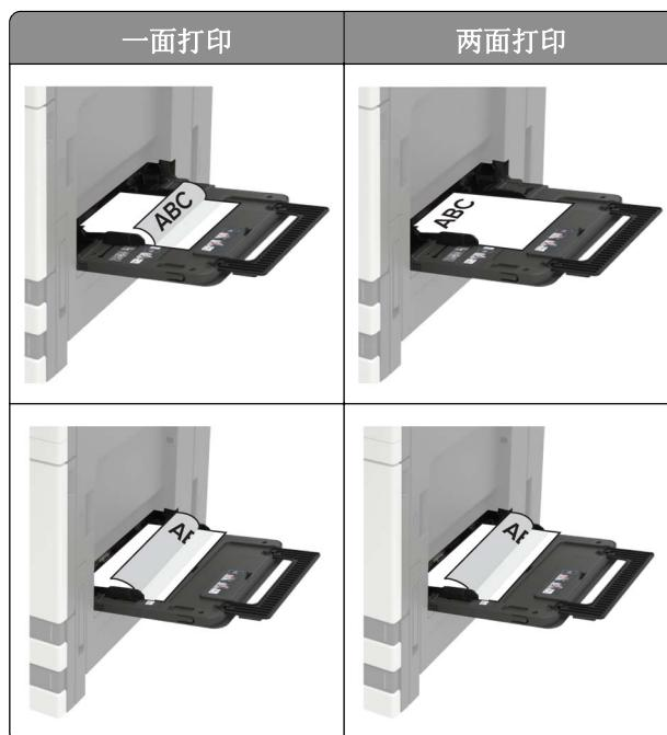
**警告—可能的损坏：**当使用信封时，不要使用带有邮票、卡扣、摁扣、窗口、涂层或自动粘胶的信封。
