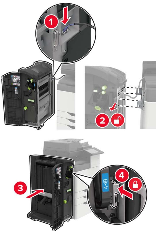
9 Vložte kazetu so spinkami do dokončovača tak, aby s cvaknutím zapadla na miesto.
