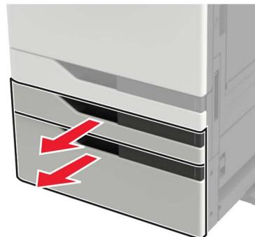
6 將用來將 2 x 500 張或 2500 張紙匣組件固定在印表機上的金屬支架和鎖定夾取下。
