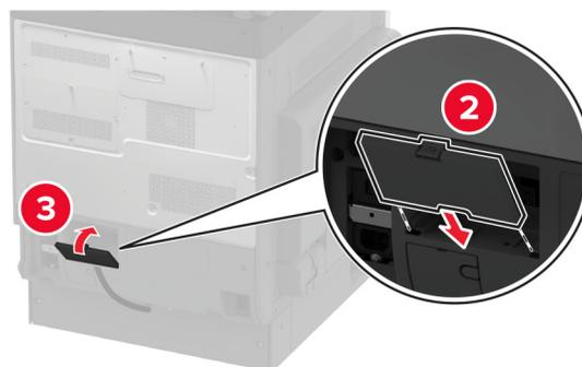
**10** Fissare la parte posteriore del vassoio opzionale alla stampante.
