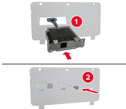
**8** Inserire il cavo del connettore del fax nel vano della scheda del controller.
