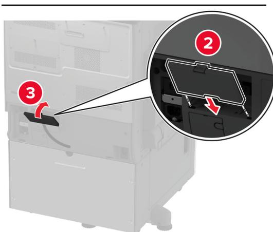
**11** Fissare la parte posteriore del vassoio opzionale alla stampante.
