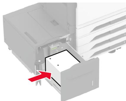
**Nota:** Accertarsi che l'altezza della risma non superi l'indicatore di livello massimo della carta. Il caricamento eccessivo del vassoio può causare inceppamenti.
