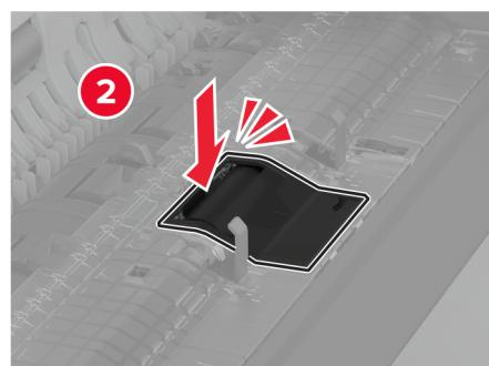
8 Uklonite sklop valjka za odvajanje.
