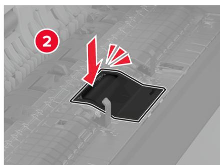
8 Uklonite iskorišćeni sklop valjka za odvajanje.
