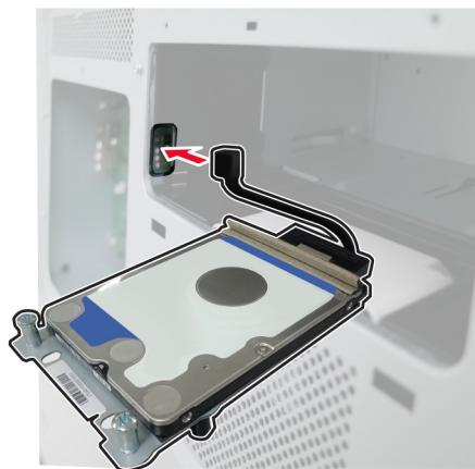
7 Postavite čvrsti disk iznad otvora za montiranje, pa ga pritisnite tako da *klikne* na mesto.
