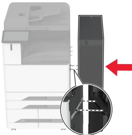
**11** Abra la puerta del clasificador para doblar en tríplico/Z, fije el clasificador a la impresora con un tornillo y, a continuación, cierre la puerta del clasificador.
