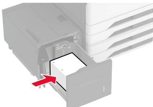
**Remarque :** Assurez-vous que la hauteur de la pile est en dessous du repère de chargement maximal. Tout chargement excessif peut provoquer des brouillages.
