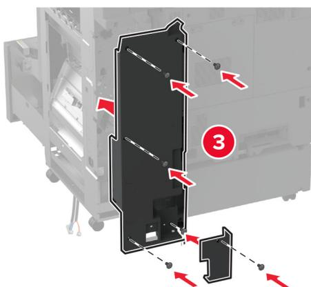
**14** Fixez la clé à l'unité de finition de pliage triple/en Z.
