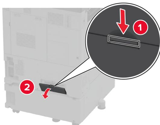
**12** Fixez le support de verrouillage sur l'imprimante, puis fixez le capot.
