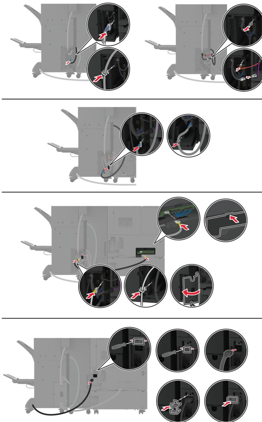
**19** Branchez les câbles d'alimentation de l'imprimante et de l'unité de finition à l'imprimante et à l'unité de finition, puis à la prise électrique.
