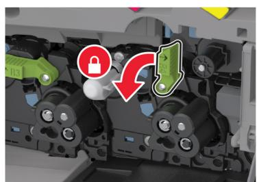
8 移除打印头刷片，然后清洁打印头镜片。
