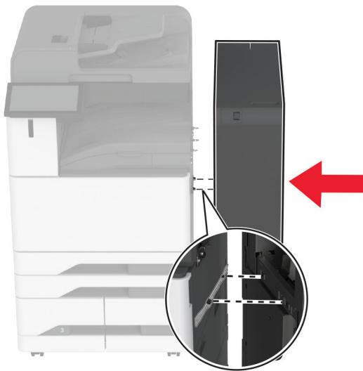
**11** 打开三折/Z-fold 装订器盖门，使用螺钉将装订器固定到打印机上，然后关闭装订器盖门。
