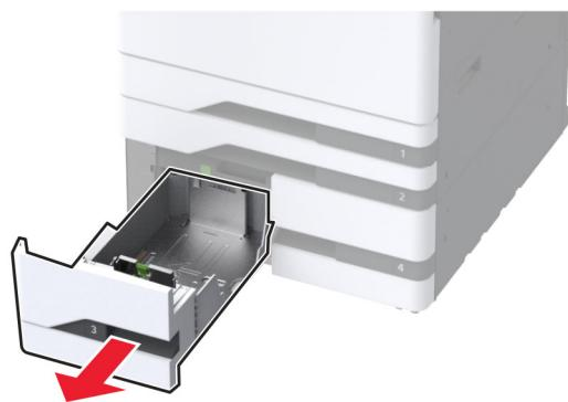
**2** 调整导片以匹配加载的纸张尺寸。
