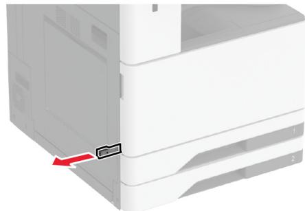
**9** Tiskalnik poravnajte z dodatnim pladnjem in ga spustite na mesto.
