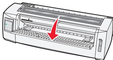
7 移动左进纸导轨，以便您想要的打印开始位置与边距导轨上印制的 [A] 符号对齐。
