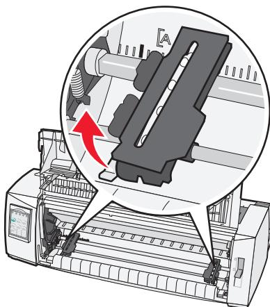
7 打开左右拖纸器盖板，然后将纸张孔眼放在拖纸器单元的第二或第三个插销上。
