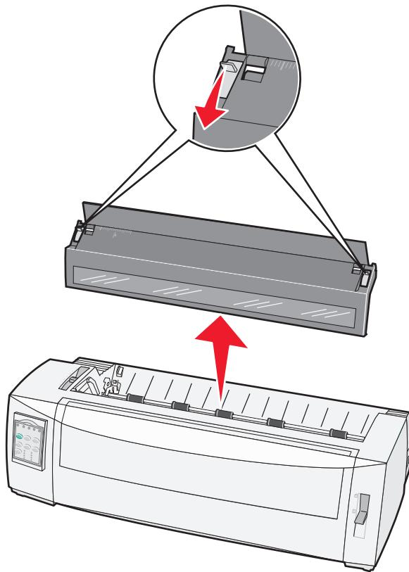
**6** 拉起左右拖纸器锁定杆以将拖纸器解锁。
