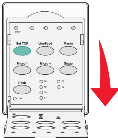
**6** 按任何纸张移动按钮（“换行”、细微↑、细微↓）以将位于滚筒上的水平线与所需的页顶对齐。
