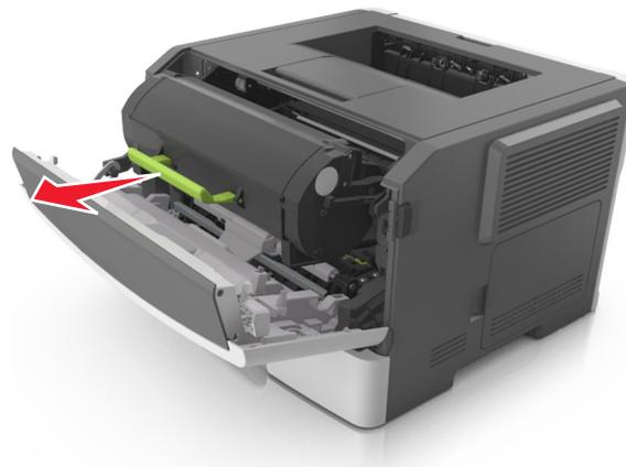
**3** Entfernen Sie die Belichtungseinheit.
