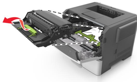
**Warnung—Mögliche Schäden:** Setzen Sie den Fotoleiter nicht länger als zehn Minuten direktem Licht aus. Wenn es zu lange dem Licht ausgesetzt ist, kann dies zu Problemen mit der Druckqualität führen.
