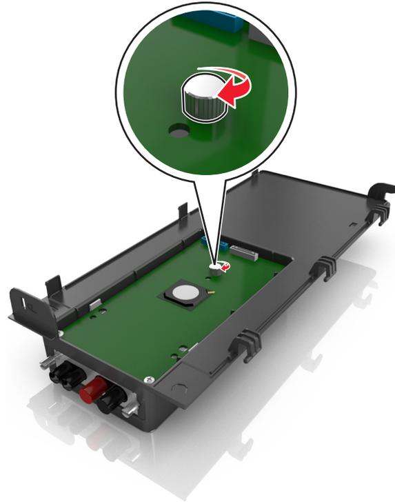
**7** Ziehen Sie die beiden Schrauben am unteren Ende der ISP-Lösung fest.
