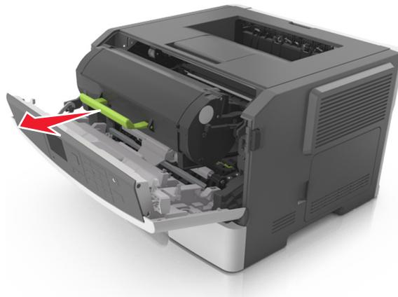
**3** Entfernen Sie die Belichtungseinheit.
