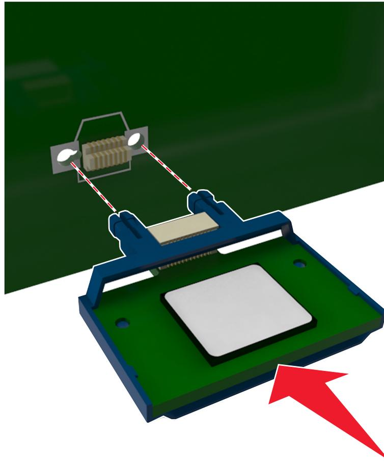
**Warnung—Mögliche Schäden:** Ein unsachgemäßer Einbau der Karte kann Schäden an der Karte und an der Steuerungsplatine zur Folge haben.
