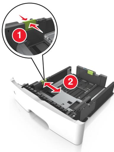
3 根據您所載入的紙張尺寸，捏住後移動長度導引夾定位拉片，然後滑至正確的位置。
