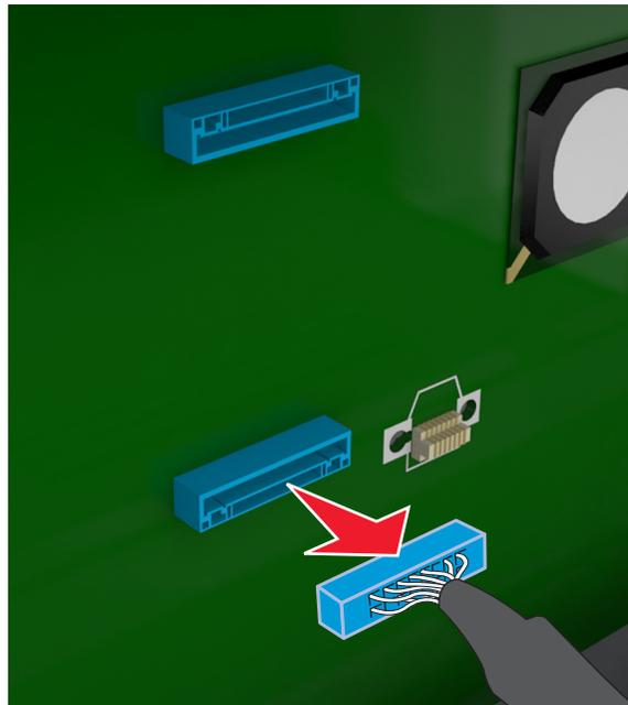
**4** 由邊緣握住印表機硬碟，然後從印表機取出該硬碟。
