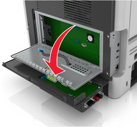
12 將 ISP 解決方案介面電纜的藍色插頭，連接至控制板上的藍色連結器。
