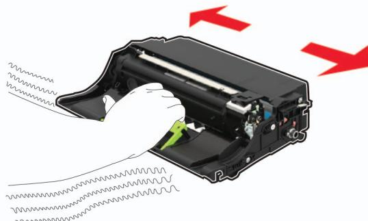
**Upozorenje—potencijalno oštećenje:** Ne izlažite ispisnu jedinicu izravnom svjetlu na duže od 10 minuta. Duže izlaganje svjetlu može uzrokovati probleme s kvalitetom ispisa.
