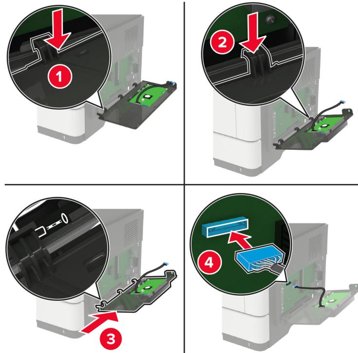
Ako je instaliran tvrdi disk pisača, uklonite tvrdi disk prije nego što instalirate ISP.
