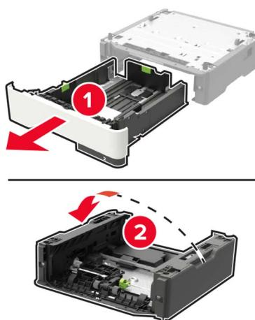
5 Izvadite iskorišteni sklop valjka za uvođenje.
