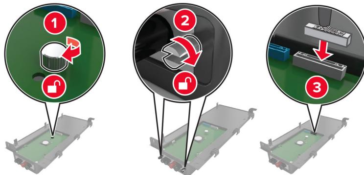
6 Otvorite, a zatim skinite pristupni poklopac ploče kontrolera.
