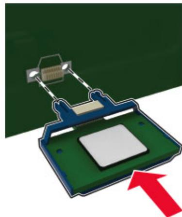
**請注意：**插卡上的整個接頭長度都必須碰觸並緊靠控制板。
