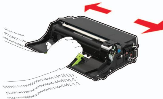
**請當心一潛藏損壞危險性：**成像組件直接曝露在光線下的時間不宜超過 10 分鐘。曝露在光線下太久，會導致列印品質發生問題。
