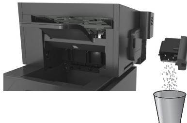
**3** 将已清空的打孔箱插回装订完成器中，直到它发出“咔嗒”一声，卡入到位。
