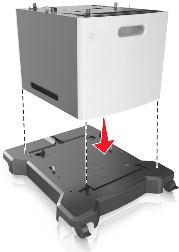
**8** 将打印机与进纸匣对齐，然后缓慢地将打印机向下放到位。
