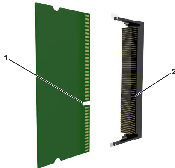
**4** 将内存卡笔直推入连接器中，然后将卡朝着控制器板墙推，直到它发出“喀嗒”一声，卡入到位。
