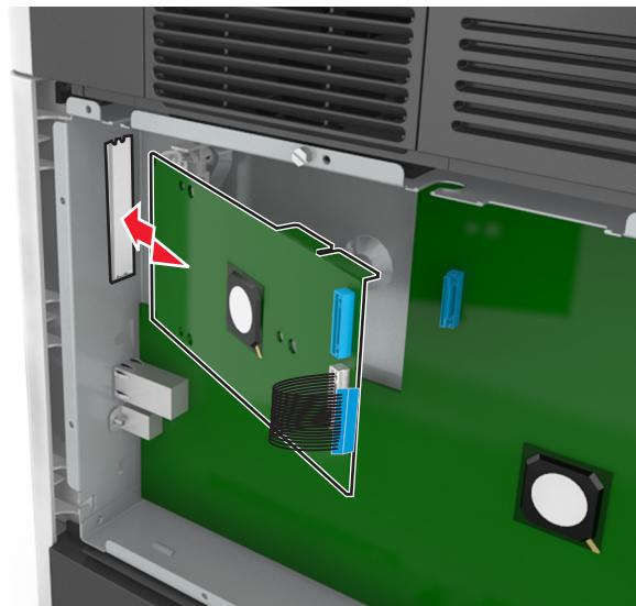
**注意:** 使 ISP 在塑料支架上面呈一定角度，以便让任何伸出的连接器能通过控制器板框架中的 ISP 开口。
