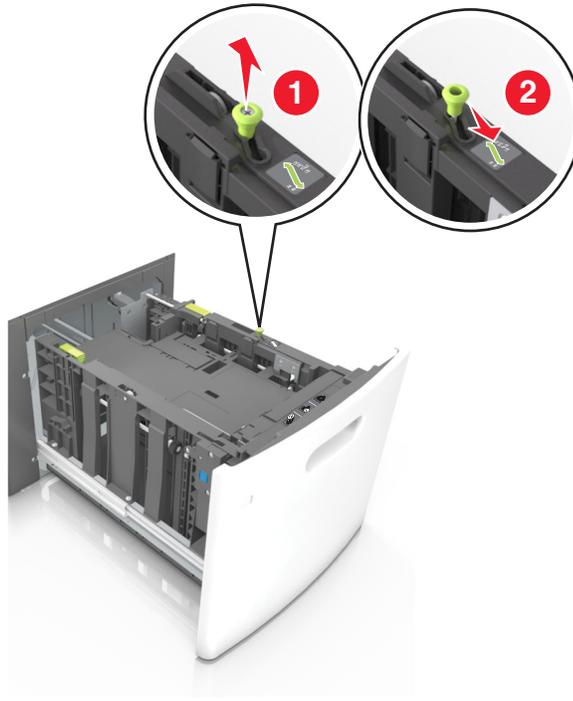
**b** 捏住長度導引夾，將它滑到 A5 適用的位置，直到它發出喀嚓一聲，卡入定位。
