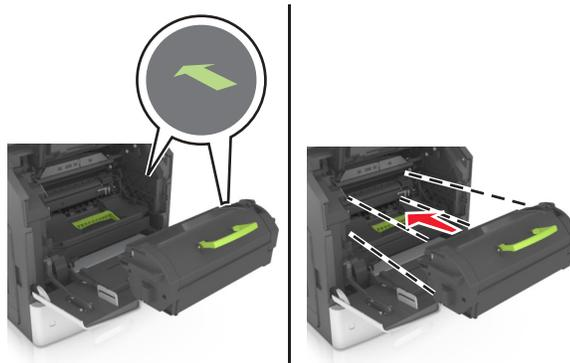
**請當心—潛藏損壞危險性：**更換碳粉匣時，請不要讓成像組件曝露於直接照射的光線過久的時間。曝露在光線下太久，會導致列印品質發生問題。
