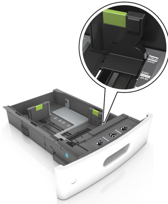
**3** 解除鎖定長度導引夾，將它捏住，然後配合載入的紙張尺寸，將導引夾滑到正確的位置。
