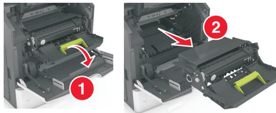
**請當心—潛藏損壞危險性：**成像組件直接曝露在光線下的時間不宜超過 10 分鐘。曝露在光線下太久，會導致列印品質發生問題。
