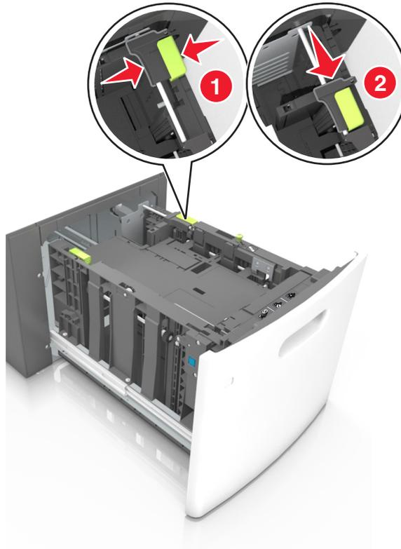
**c** 從 A5 長度導引夾的夾具中，取出 A5 長度導引夾。
