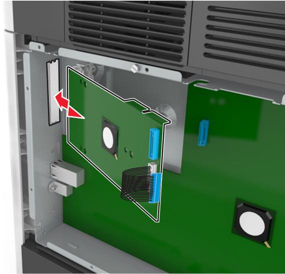
**請注意：**以某個角度將 ISP 擺放至塑膠支架上方，使懸空的所有連結器，都能穿過控制板箱匣中的 ISP 開口處。
