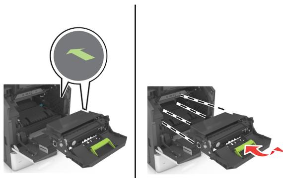
7 將碳粉匣插入印表機，插入時，請將碳粉匣邊欄上的箭頭對準印表機內側邊欄上的箭頭。
