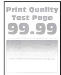
**ملاحظة:** قبل حل المشكلة، اطبع صفحات اختبار جودة الطباعة. من لوحة التحكم، انتقل إلى الإعدادات > استكشاف الأخطاء وإصلاحها > صفحات اختبار جودة الطباعة. في طرازات الطابعات المزودة بشاشات لا تعمل باللمس، اضغط على **OK** للانتقال عبر الإعدادات.
