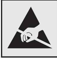
هذا الرمز يحدد الأجزاء الحساسة للكهرباء الاستاتيكية. لا تلمس المناطق القريبة من هذه الرموز دون لمس سطح معدني أولاً في منطقة بعيدة من الرمز. لتجنب حدوث تلف ناجم عن التفريغ الكهربائي عند تنفيذ مهام الصيانة مثل إزالة انحناس الورق أو استبدال المستلزمات، المس أي إطار معدني مكشوف للطابعة قبل الوصول إلى المناطق الداخلية في الطابعة أو لمسها حتى إذا لم يكن الرمز موجوداً.
