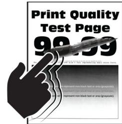
**ملاحظة:** قبل حل المشكلة، اطبع صفحات اختبار جودة الطباعة. من لوحة التحكم، انتقل إلى الإعدادات > استكشاف الأخطاء وإصلاحها > صفحات اختبار جودة الطباعة. في طرازات الطابعات المزودة بشاشات لا تعمل باللمس، اضغط على **OK** للانتقل عبر الإعدادات.
