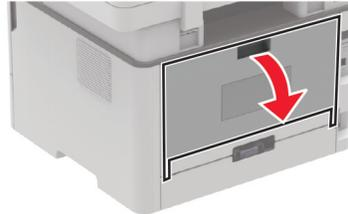
2 Öffnen Sie die Zugriffsklappe der Fixierstation.
