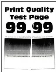
**Hinweis:** Drucken Sie die Seiten für Druckqualitätstests aus, bevor Sie das Problem beheben. Gehen Sie an der Bedieneinheit zu **Einstellungen > Fehlersuche > Testseiten für Druckqualität**. Drücken Sie bei Druckermodellen ohne Touchscreen **OK**, um durch die Einstellungen zu navigieren.
