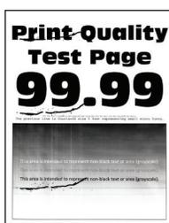
**Remarque :** Avant de résoudre le problème, imprimez les pages de test de qualité d'impression. Sur le panneau de commandes, accédez à **Paramètres > Dépannage > Pages de test de qualité d'impression**. Sur les modèles d'imprimante sans écran tactile, appuyez sur **OK** pour parcourir les paramètres.
