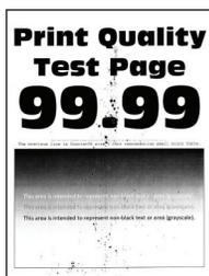
**Remarque** : Avant de résoudre le problème, imprimez les pages de test de qualité d'impression. A partir du panneau de commandes, accédez à **Paramètres > Dépannage > Pages de test de qualité d'impression**. Pour les modèles d'imprimante sans écran tactile, appuyez sur **OK** pour parcourir les paramètres.
