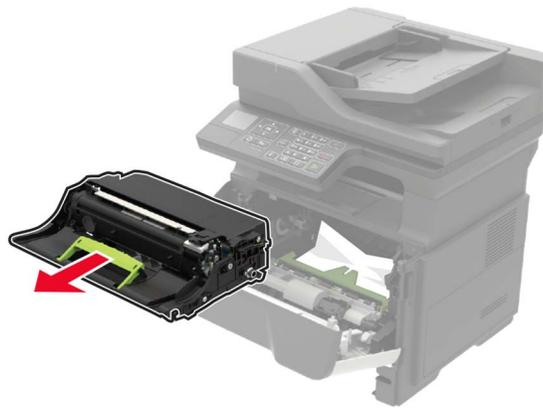
**Upozorenje—potencijalno oštećenje:** Ne izlažite ispisnu jedinicu izravnom svjetlu na duže od 10 minuta. Duže izlaganje svjetlu može uzrokovati probleme s kvalitetom ispisa.
