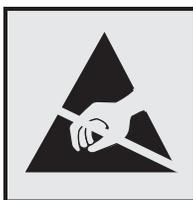
Этим знаком обозначаются компоненты, чувствительные к статическому электричеству. Перед тем, как прикасаться к поверхностям, отмеченным такими знаками, необходимо дотронуться до металлической поверхности вне области, отмеченной символом.
