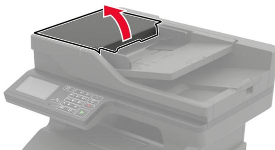
**2** Retire el rodillo de separación del ADF.
