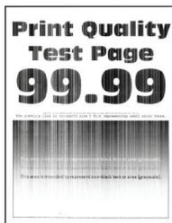
**メモ:** 問題を解決する前に、印刷品質テストページを印刷します。操作パネルから、[設定] > [トラブルシューティング] > [印刷品質テストページ]に移動します。タッチ画面のないプリンタ機種では、**OK** を押して設定内を移動します。
