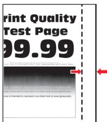
**メモ:** 問題を解決する前に、印刷品質テストページを印刷します。操作パネルから、**[設定]** > **[トラブルシューティング]** > **[印刷品質テストページ]**の順に移動します。タッチ画面のないプリンタ機種では、**OK** を押して設定内を移動します。
