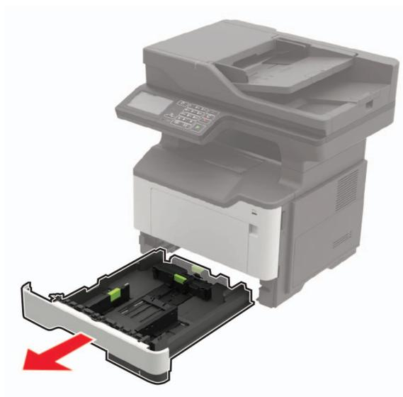
2 セットする用紙のサイズに合わせて用紙ガイドを調整します。
