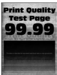
**メモ:** 問題を解決する前に、印刷品質テストページを印刷します。操作パネルから、**設定 > 問題に対処する > 印刷品質テストページ**に移動します。タッチ画面のないプリンタ機種では、**OK** を押して設定内を移動します。
