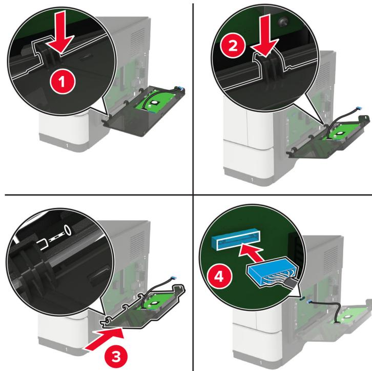
若目前已安裝印表機硬碟，請在安裝 ISP 前移除硬碟。
