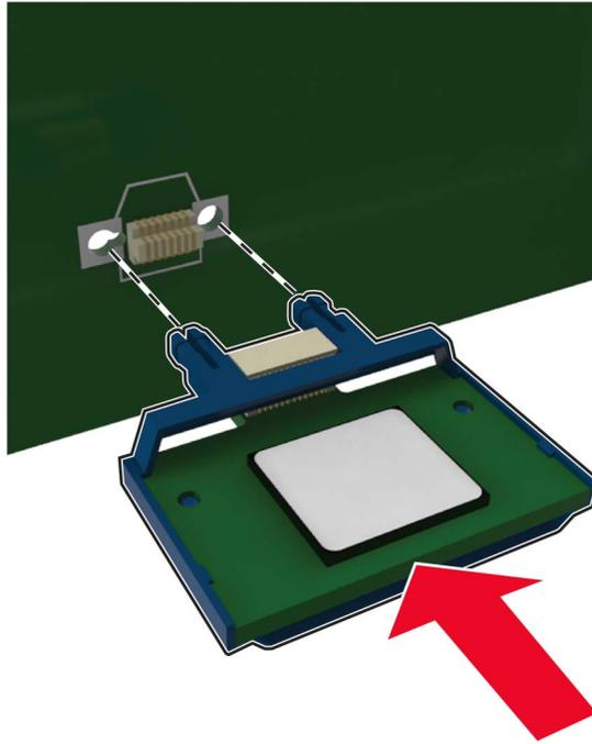
**請注意：**插卡上的整個接頭長度都必須碰觸並緊靠控制板。
