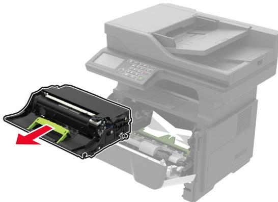
**請當心—潛藏損壞危險性：**成像組件直接曝露在光線下的時間不宜超過 10 分鐘。曝露在光線下太久，會導致列印品質發生問題。
