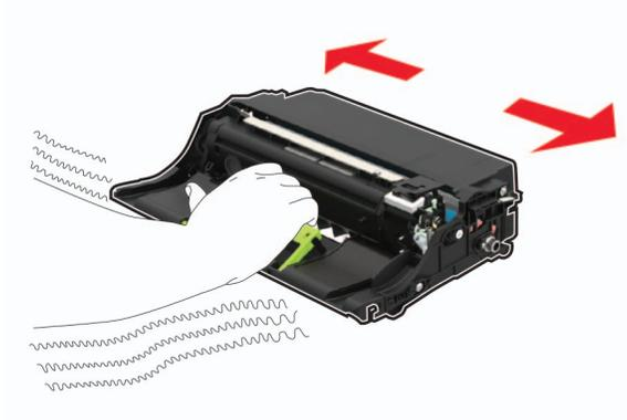
**請當心—潛藏損壞危險性：**成像組件直接曝露在光線下的時間不宜超過 10 分鐘。曝露在光線下太久，會導致列印品質發生問題。
