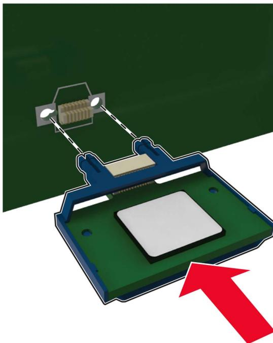
**Примечание:** Разъем платы микропрограммного обеспечения должен соприкасаться с системной платой по всей длине и располагаться в одной плоскости с ней.
