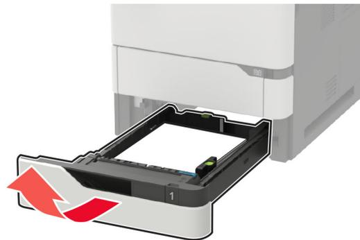
**تحذير—تلف محتمل:** تتعرض أداة الاستشعار المتوفرة داخل الدرج الاختياري للتلف بسهولة بسبب الكهرباء الاستاتيكية. المس سطحاً معدنياً قبل إزالة الورق المنحشر من الدرج.
