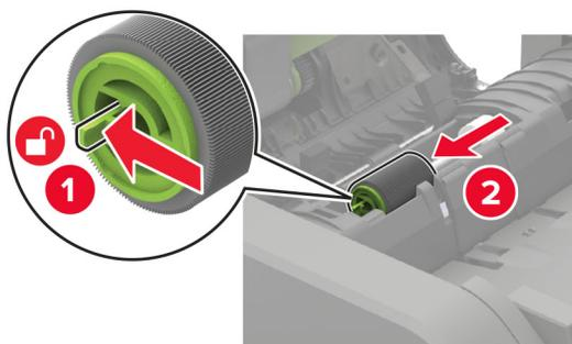
**5** Rimuovere il limitatore di torsione ADF usato.
