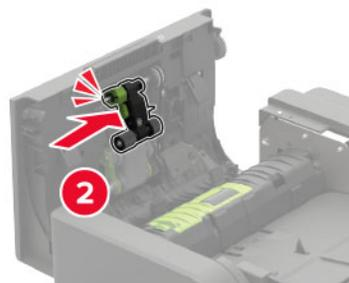
7 Установите крышку валика захвата УАПД до защелкивания на месте.
