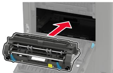
7 Закрепите валик для термического закрепления.
