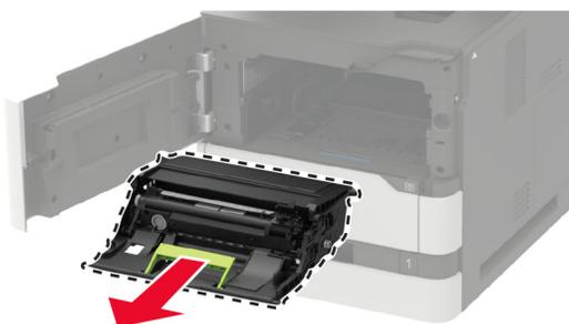
4 Извлеките блок копи-картриджа из упаковки, а затем потрясите его, чтобы распределить внутри тонер.
