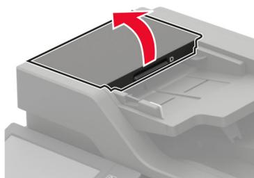
3 Снимите крышку разделяющего валика УАПД.
