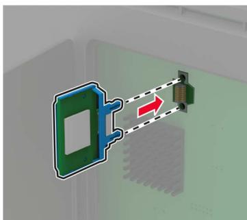
**Примечание:** Разъем платы микропрограммного обеспечения должен соприкасаться с системной платой по всей длине и располагаться в одной плоскости с ней.
