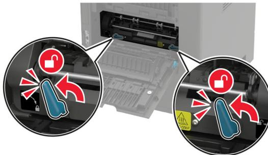
4 Извлеките использованный валик для термического закрепления.
