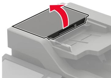
**3** Снимите крышку валика захвата УАПД.
