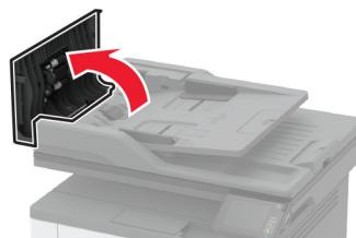
2 Izvadite iskorištenu podlogu ADF-a za odvajanje.
