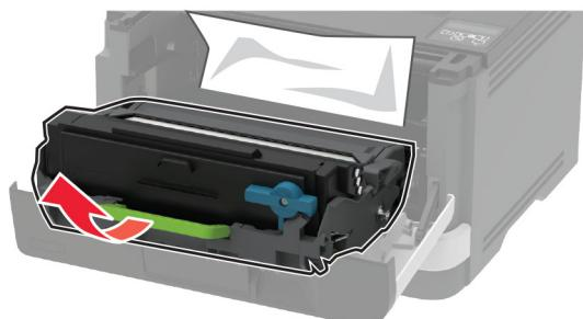
**Upozorenje—potencijalno oštećenje:** Ne izlažite ispisnu jedinicu izravnom svjetlu na duže od 10 minuta. Duže izlaganje svjetlu može uzrokovati probleme s kvalitetom ispisa.
