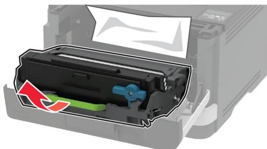
**Advarsel – mulig skade:** Ikke utsett bildeenheten for direkte lys i mer enn ti minutter. Lengre eksponering for lys kan føre til problemer med utskriftskvaliteten.
