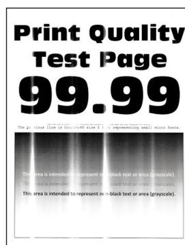
[Vertikale lyse striper på side 167](#)
