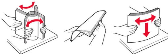
4 Coloque a pilha de papel com o lado a ser impresso voltado para baixo e, em seguida, certifique-se de que as guias se ajustem com firmeza à pilha de papel.
