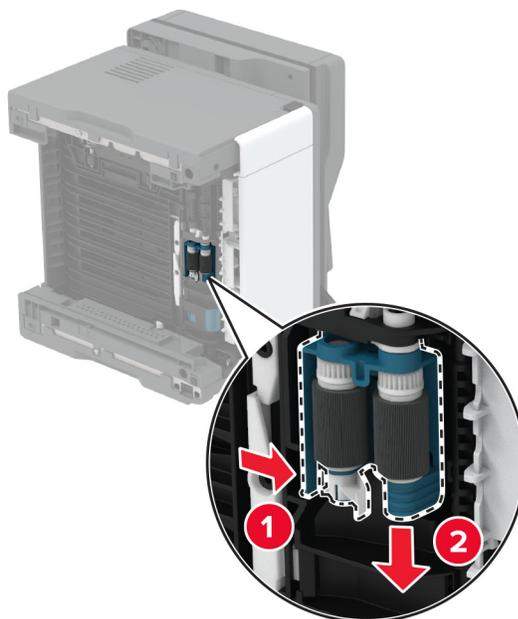
**9** Aplique álcool isopropílico em um pano macio e sem fiapos e limpe o conjunto do rolo de coleta.
