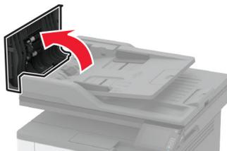
2 Remova a almofada separadora do ADF usada.
