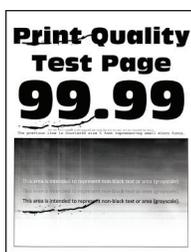
**Nota:** Antes de solucionar o problema, imprima as páginas de teste de qualidade de impressão. No painel de controle, navegue até **Configurações > Solução de problemas > Páginas de teste de qualidade de impressão**. Para modelos de impressora que não sejam de tela sensível ao toque, pressione **OK** para navegar pelas configurações.
