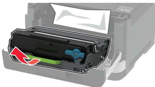
**警告—可能的损坏：**不要让成像部件暴露在直射光线下超过 10 分钟。长时间暴露在光线下可能导致打印质量问题。
