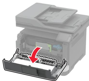
**2** Uklonite iskorišćenu jedinicu za izradu slika.
