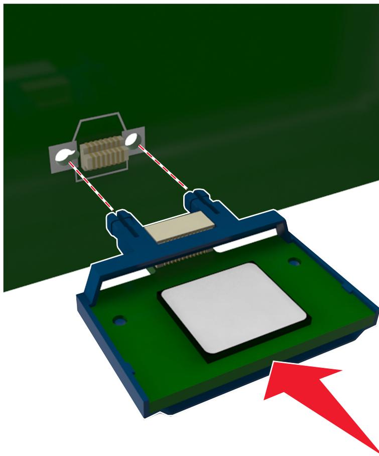
**Aviso — Danos potenciais:** A instalação incorreta da placa pode causar danos à placa e à placa do controlador.
