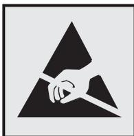
Этим знаком обозначаются компоненты, чувствительные к статическому электричеству. Перед тем, как прикоснуться к поверхностям, отмеченным такими знаками, необходимо дотронуться до металлической поверхности вне области, отмеченной символом.
