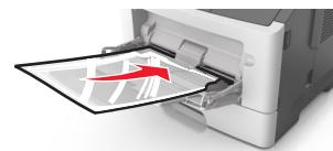
**Notă:** Când încărcați hârtie de dimensiune A6, asigurați-vă că sistemul de extindere al alimentatorului multifuncțional atinge ușor marginea hârtiei, pentru ca ultimele câteva coli de hârtie să rămână fixate.
