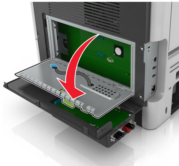
**13** Conectați mufa albastră a cablului de interfață al soluției ISP la priza albastră de pe placă controllerului.
