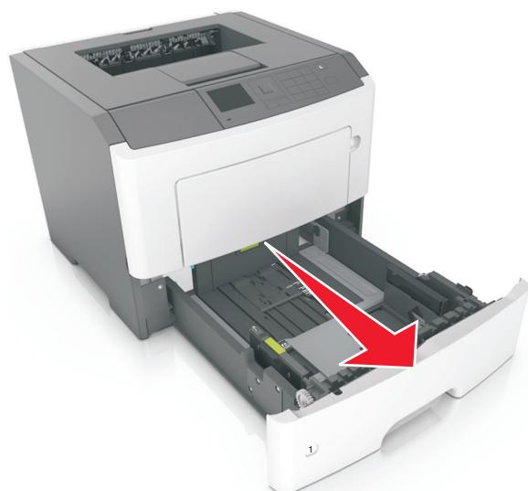
**2** Strângeți și mutați ghidajul pentru lățime în poziția corectă pentru dimensiunea hârtiei pe care o încărcați.
