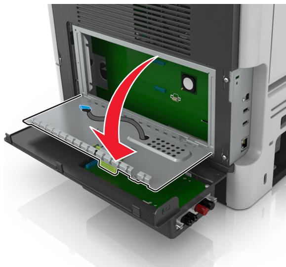
13 将 ISP 解决方案接口电缆的蓝色插头连接到控制器板上的蓝色插座中。
