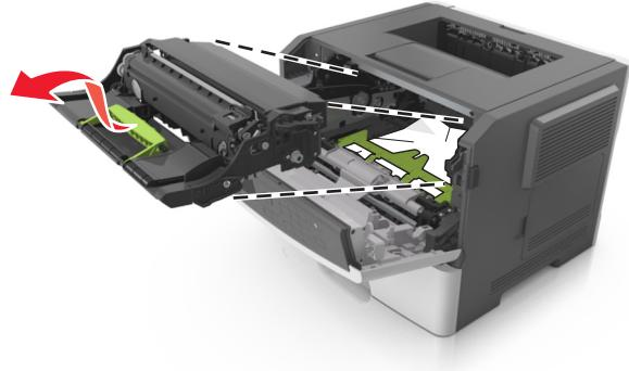
**警告—可能的损坏：**不要让成像部件暴露在直射光线下超过 10 分钟。长时间暴露在光线下可能导致打印质量问题。
