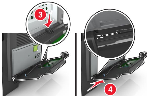
11 将 ISP 电缆穿过控制器板挡板。
