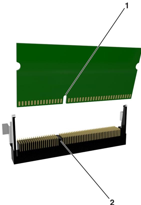
4 将内存卡笔直推入连接器中并向前推入控制器板墙中，直到它发出“喀”一声，卡入到位。
